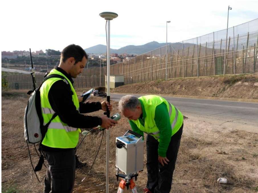
Figura 7: Realización de una medida gravimétrica sobre trípode y adquisición de las coordenadas del punto de medida con el GPS diferencial.
